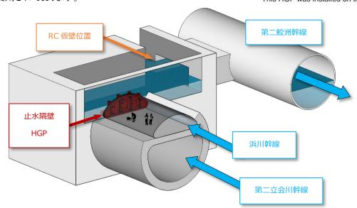
トンネル断面が円形ではなく特殊形状であるため、止水機構には 従来のゴムリングタイプ(ヘキサプラグ形式)ではなく、加圧式チュ ーブシールタイプを採用しました。又、作業員の安全を考慮し操 作性に優れた水密扉が付いております。
